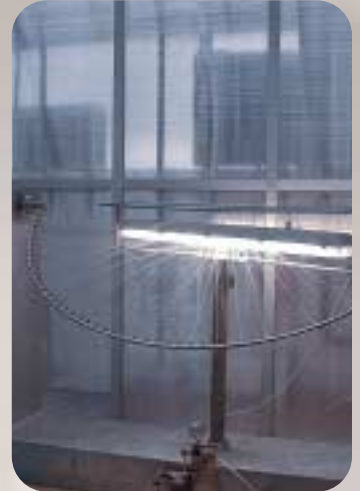
IP próba: a védettségi fokot méri
